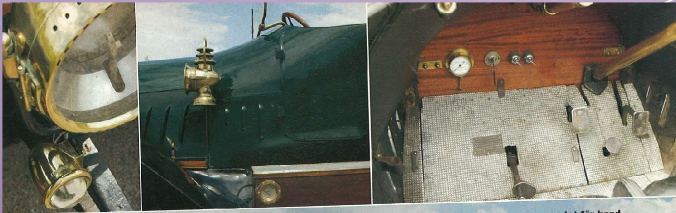
Den enda instrumenteringen som finns är bensintycksmätare. När trycket är för lågt måste föraren pumpa upp det för hand. Bilen har gasbelysning och gastuben förvaras i låda på vänster fotsteg.
