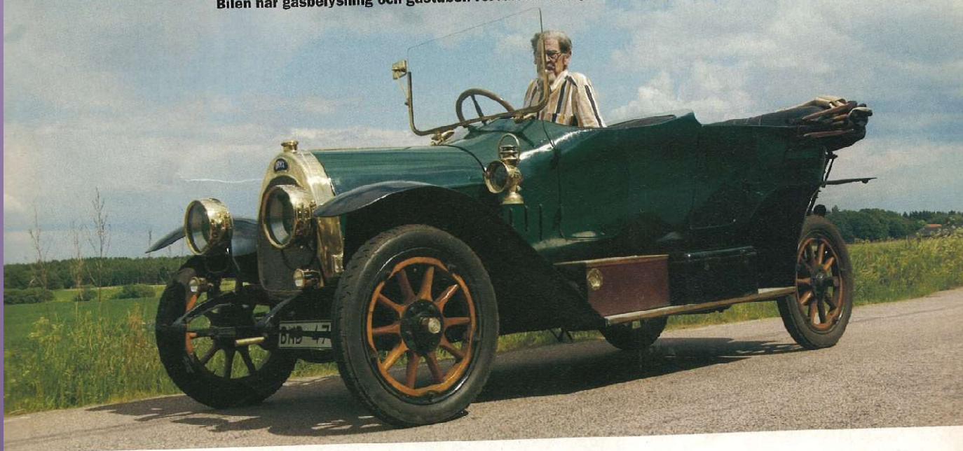
Den enda instrumenteringen som finns är bensintycksmätare. När trycket är för lågt måste föraren pumpa upp det för hand. Bilen har gasbelysning och gastuben förvaras i låda på vänster fotsteg.
